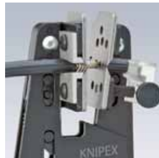
Automatické stažení izolace
