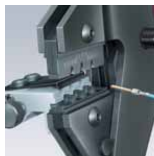
97 43 200 s profilem 97 49 24 pro lisování konektorů D-Sub
