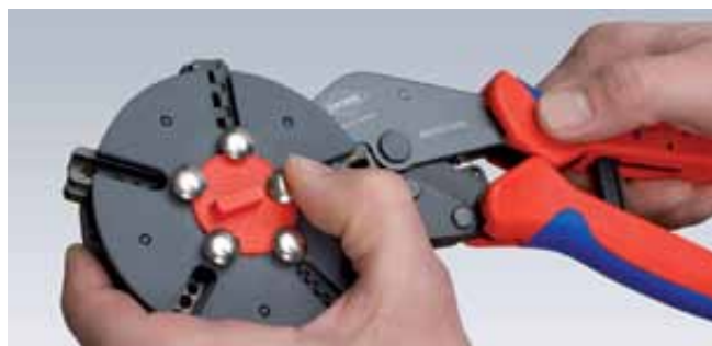
Výměna krimpovacího nástavce: Odaretujte polohu zásobníku, sejměte krimpovací nástavec z kleští.
