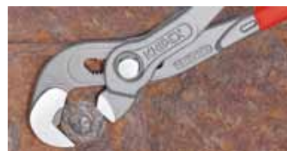
Rezavé matice nebo matice se zaoblenými hranami
